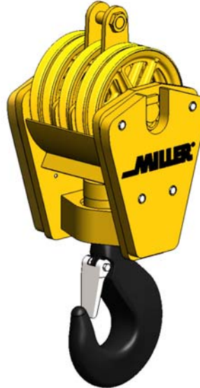
N.º DE MODELO: 520H80 - 5 POLEAS, DIÁMETRO 20" - PESOS DE CACHETE - WLL: 80 tons
