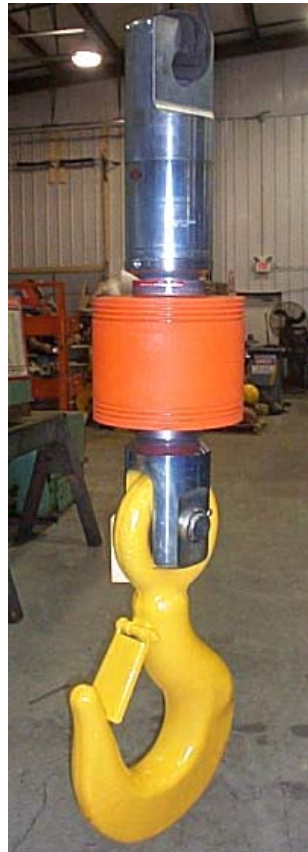
Aislado, 60 ton, operaciones de mantenimiento de transbordador espacial de NASA
