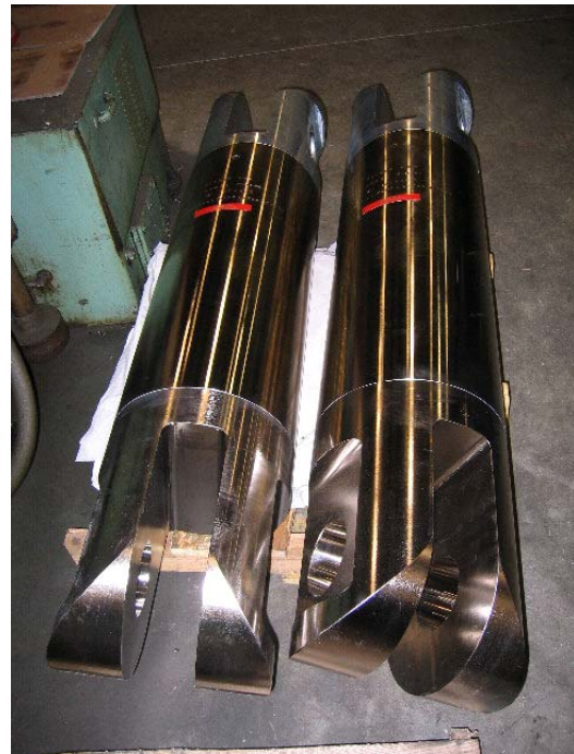
375 ton, costa afuera, especial para conexión de ductos ascendentes catenarios (SCR pull-in)
